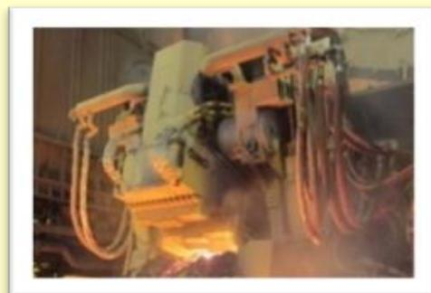
電気炉炉体の排滓口に取り付け密閉度の高いスラグドアとなります。プッシャーで排滓口を清掃し詰まりをなくし、排滓口を常に一定の形状に整えます。
